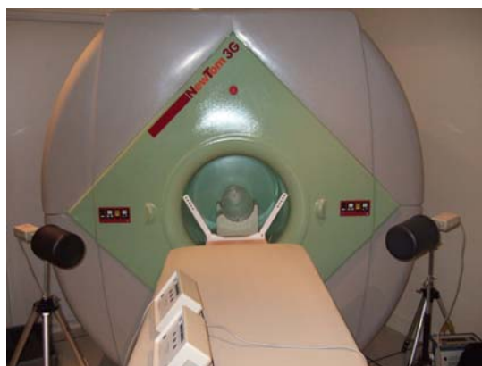
Figure 25 - Vue générale de l'appareil de radiologie dentaire de type « NewTom 3G » et mise en place des chambres d'ionisation utilisées pour la mesure du rayonnement
