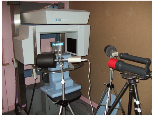
Figure 28 - Vue générale de l'appareil de tomographie à faisceau conique de type « I-CAT » et positionnement des appareils de mesure
