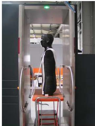
Figure 35 - Fantôme anthropomorphe équivalent tissu de type ALDERSON-RANDO lors d'un contrôle avec le Body Scanner BS 16HR DV<sup>®</sup>
