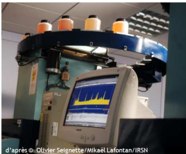
Figure 19 - Mesure de la radioactivité au sein d'échantillons urinaires par spectrométrie \gamma dans le cadre d'analyses radiotoxicologiques
